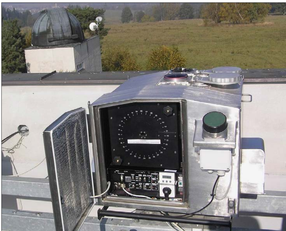
Automatická bolidová kamera Astronomického ústavu AV ČR
