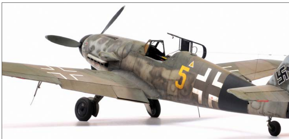
Letadlo mělo rozpětí křídel 9,924 m, délku 8,94 m, max. rychlost 655 km/h a max. dolet 850 km, celkem se jich vyrobilo asi 2600 ks.
